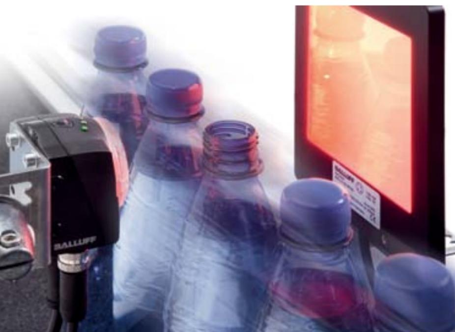
Фоновая подсветка подходит для метода сквозного луча или рассеянного освещения объекта. При использовании фоновой подсветки контуры объекта становятся четче, что позволяет делать более точное сравнение.
